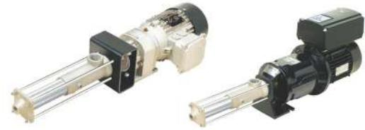
Ces pompes sont développées pour des applications à faible débit qui nécessitent des précisions et une répétabilité élevée. Ces pompes peuvent traiter une grande variété de fluides allant des liquides propres et clairs aux fluides abrasifs, corrosifs, visqueux et solides. La précision de répétabilité a moins de 1% de fluctuation. Disponible en 6 capacités et 3 plages de pression (6 – 12 – 24 bar)
