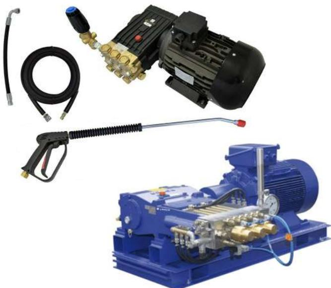
Les pompes à piston triplex Mouvex sont des pompes alternatives conçues conformément à l'API 674 ou ISO 13710. Ces pompes sont idéales dans les applications critiques où une haute pression est nécessaire, y compris l'injection pour les unités de déshydratation de gaz naturel, l'injection de méthanol pour prévenir la formation de bouchons d'hydrates aux têtes de puits sous-marines et injection d'acide borique.
