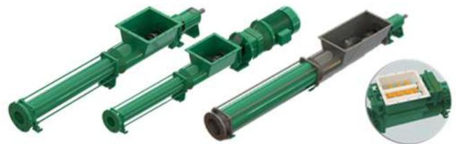
L'entrée de ce type à large gorge permet l'écoulement par gravité des matériaux très visqueux (plasto-visqueux) sur la vis de gavage qui pousse la substance vers l'élément de pompage. Les pompes à large gorge avec dispositif de rupture de pont en haut sont conçues pour manipuler des fluides extrêmement difficiles à très haute teneur en solides.
