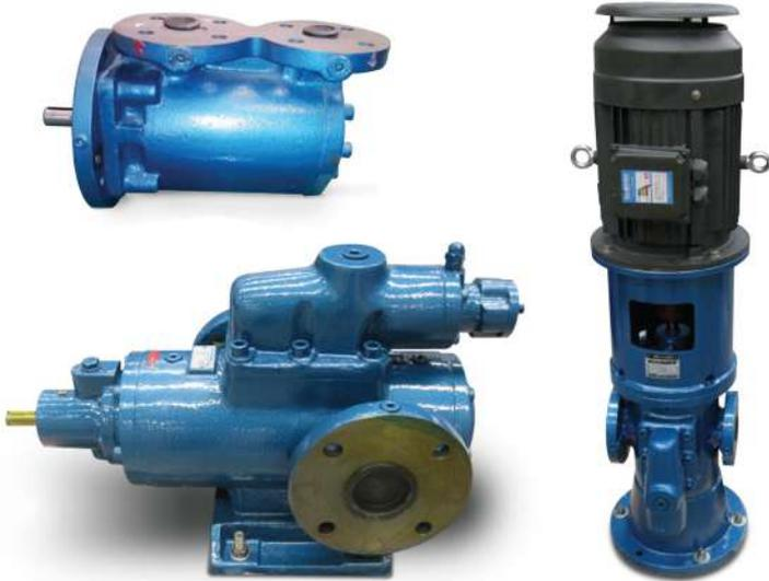
Les pompes à trois vis sont conçues pour les applications à moyenne et haute pression. Ces pompes volumétriques auto-amorçantes sont équilibrées à basse pression et doivent être utilisées comme pompe de transfert et surpression, d'alimentation des fours à combustible; d'huile lubrifiante dans les applications industrielles et dans les systèmes de transmission hydrauliques.
