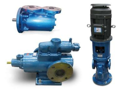
Les pompes à trois vis sont conçues pour les applications à moyenne et haute pression. Ces pompes volumétriques auto-amorçantes sont équilibrées à basse pression et doivent être utilisées comme pompe de transfert et surpression, d'alimentation des fours à combustible; d'huile lubrifiante dans les applications industrielles et dans les systèmes de transmission hydrauliques.
